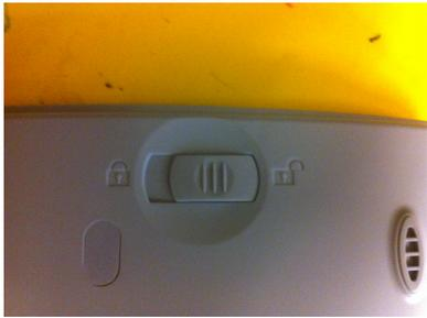
Sous le scanner, il y a un cadenas de verrouillage: déverrouillez-le.
